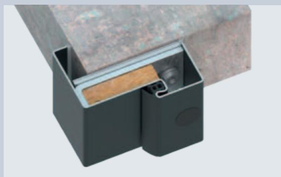
3. Anschlussfugen versiegeln und Dübel-Befestigungslöcher abdecken
